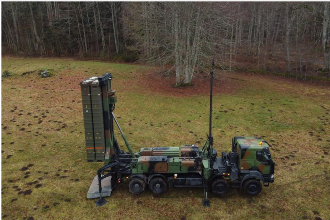
Εικόνα 6: Εκτοξευτήρας του α/α συστήματος SAMP/T ( https://euosam.com/ground-systems/ )
